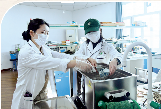
将瓷片放入超声波清洗机,准备清洗。
