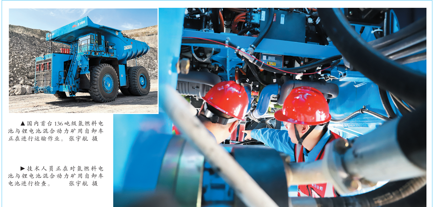
▲国内首台136吨级氢燃料电池与锂电池混合动力矿用自卸车正在进行运输作业。张宇航摄 ►技术人员正在对氢燃料电池与锂电池混合动力矿用自卸车电池进行检查。张宇航摄
